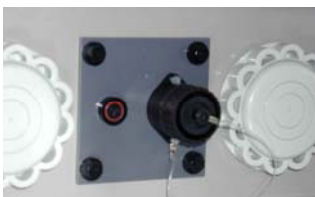
FI- Prüfsteckdose zum Prüfen des FI-Auslösestroms
